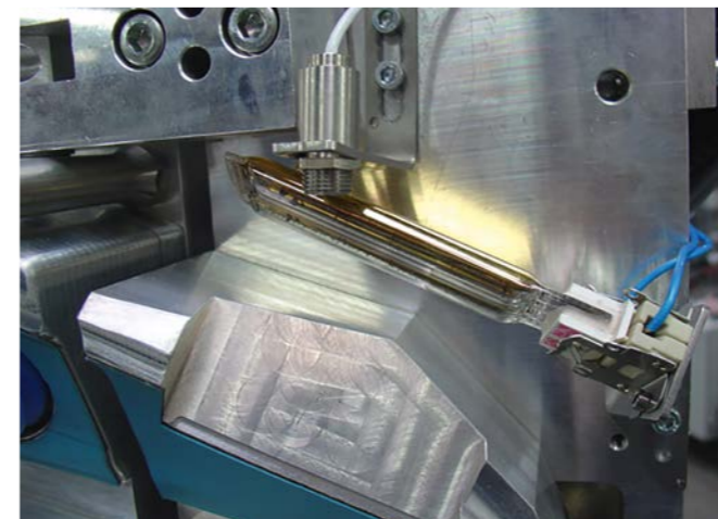
Mesure de la température par infrarouge dans les machines d'emballage
