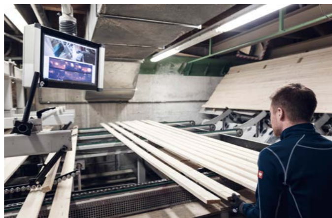
Logiciel PIX Connect pour l'observation des raboteuses. Image : binderholz
