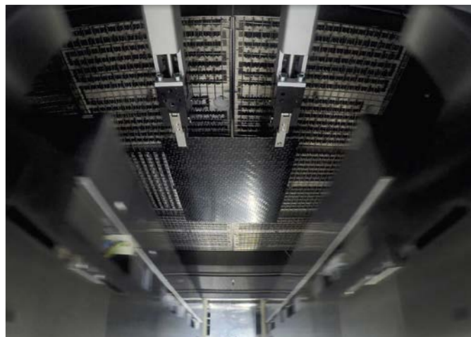
CT LT - Tête de mesure avec dispositif de purge d'air laminaire dans une machine de thermoformage
