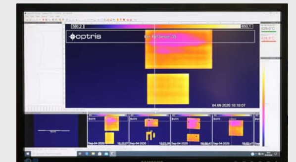
Surveillance des températures de feuilles de verre
