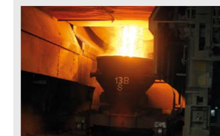
Surveillance du revêtement réfractaire d'un wagon poche et scorie se retirant de l'usine
