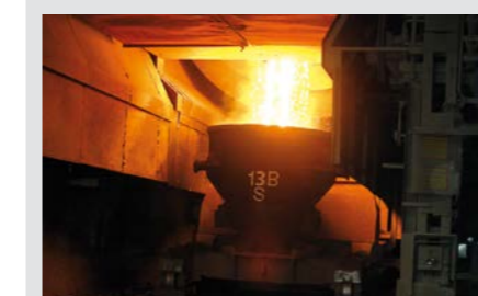
Supervisión del revestimiento refractario de un vagón caldero de escorias mientras sale por la fábrica
