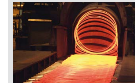
Trabajo en caliente de chapas metálicas y fabricación de alambre
