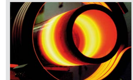
Tubería calentada por inducción
