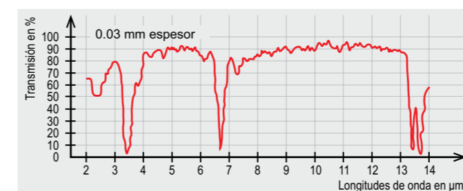
Permeabilidad espectral de láminas de plástico de polietileno
