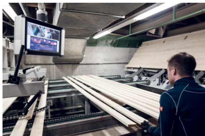
Software PIX Connect para la observación de máquinas cepilladoras. Imagen: binderholz
