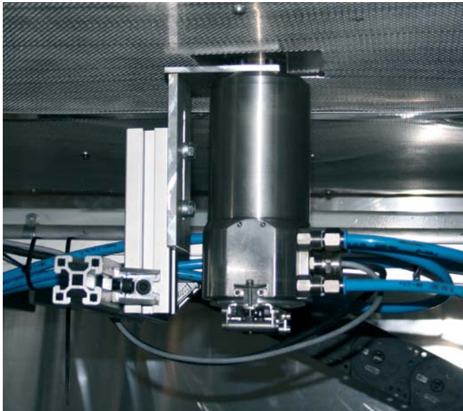
Abb. 4: Wärmebildkamera optris PI, wassergekühlt im industriellen Schutzgehäuse bei Temperaturen von bis zu 315°C einsetzbar
