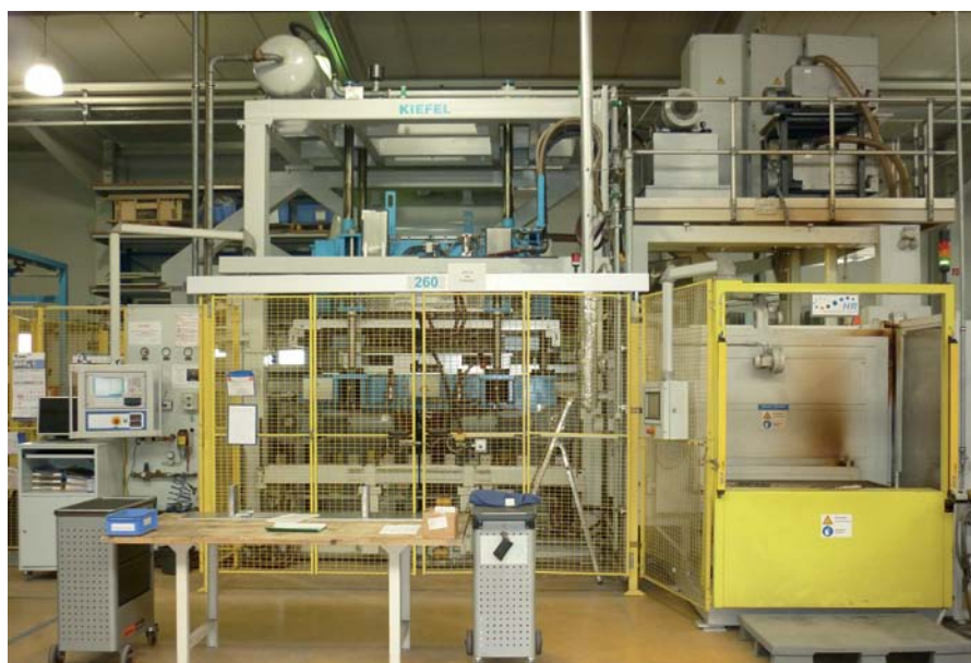
Abb. 2: Für die Produktion der Verkleidungsteile bei Jacob Composite wird eine Tiefziehanlage von Kiefel genutzt
