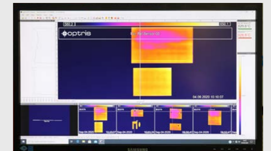
Überwachung der Temperaturen von Glasscheiben
