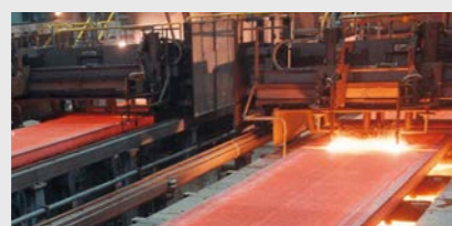
Schnelle Erfassung einer Stahlbramme zur Materialverfolgung
