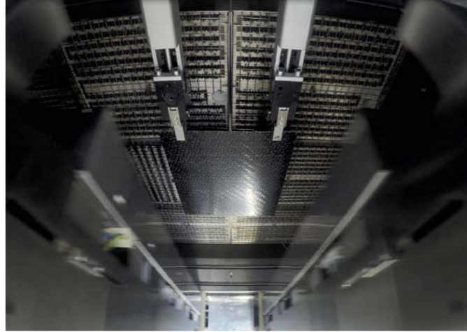
Kleiner CT LT-Messkopf mit Lamina-Freiblaseeinrichtung in einer Thermoform-Maschine
