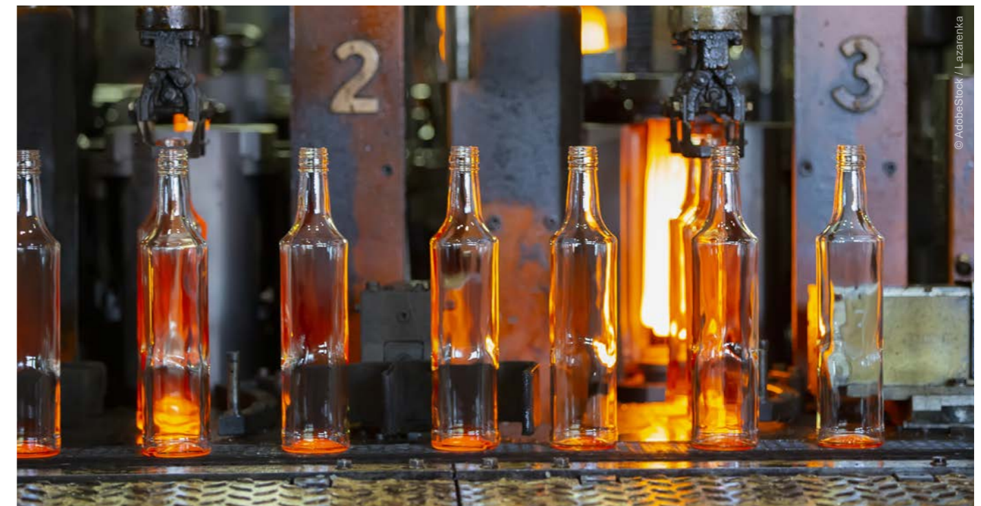
Temperaturmessung zur Qualitätskontrolle nach dem Formgebungsprozess
