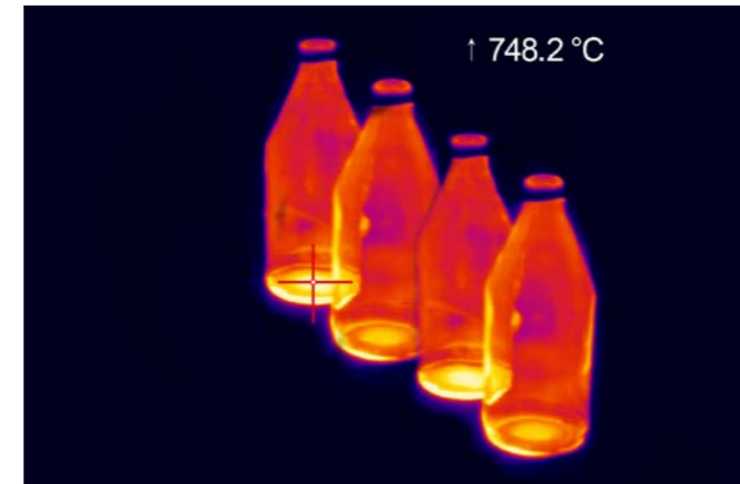
Hot-Spot-Messung bei der Herstellung von Glasflaschen
